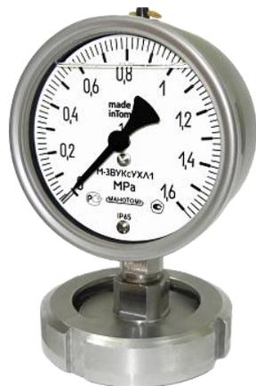
Манометр виброустойчивый коррозионностойкий М-ЗВУКс в сборе с мембранным разделителем РМ-ГМ (молочная гайка) предназначен для измерения избыточного давления сред в стерильных технологических процессах, например, на пищевых производствах.
