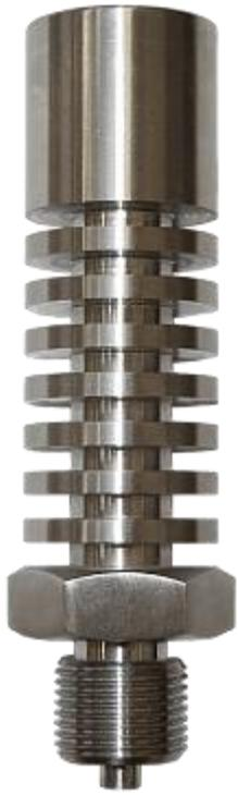
Охладитель-переходник Кс предназначен для предохранения манометров, измеряющих давление пара, горячей жидкости и других измеряемых сред, имеющих температуру выше плюс 60°C от непосредственного действия горячей среды.
