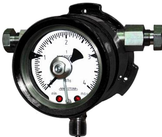
Манометры, вакуумметры, мановакуумметры типа ДМ5012СгВн, ДВ5012СгВн, ДА5012СгВн - показывающие коммутирующие приборы, предназначенные для измерения избыточного и вакуумметрического давления неагрессивных сред и управления внешними электрическими цепями с помощью коммутирующего устройства, выполненного на основе оптических датчиков и реле.
